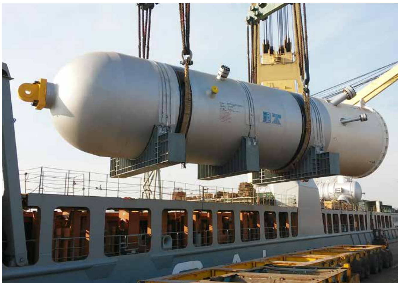
Uno dei quattro reattori in acciaio basso legato modificato al vanadio forniti da ATB Italia al progetto petrolchimico di Petronas.
