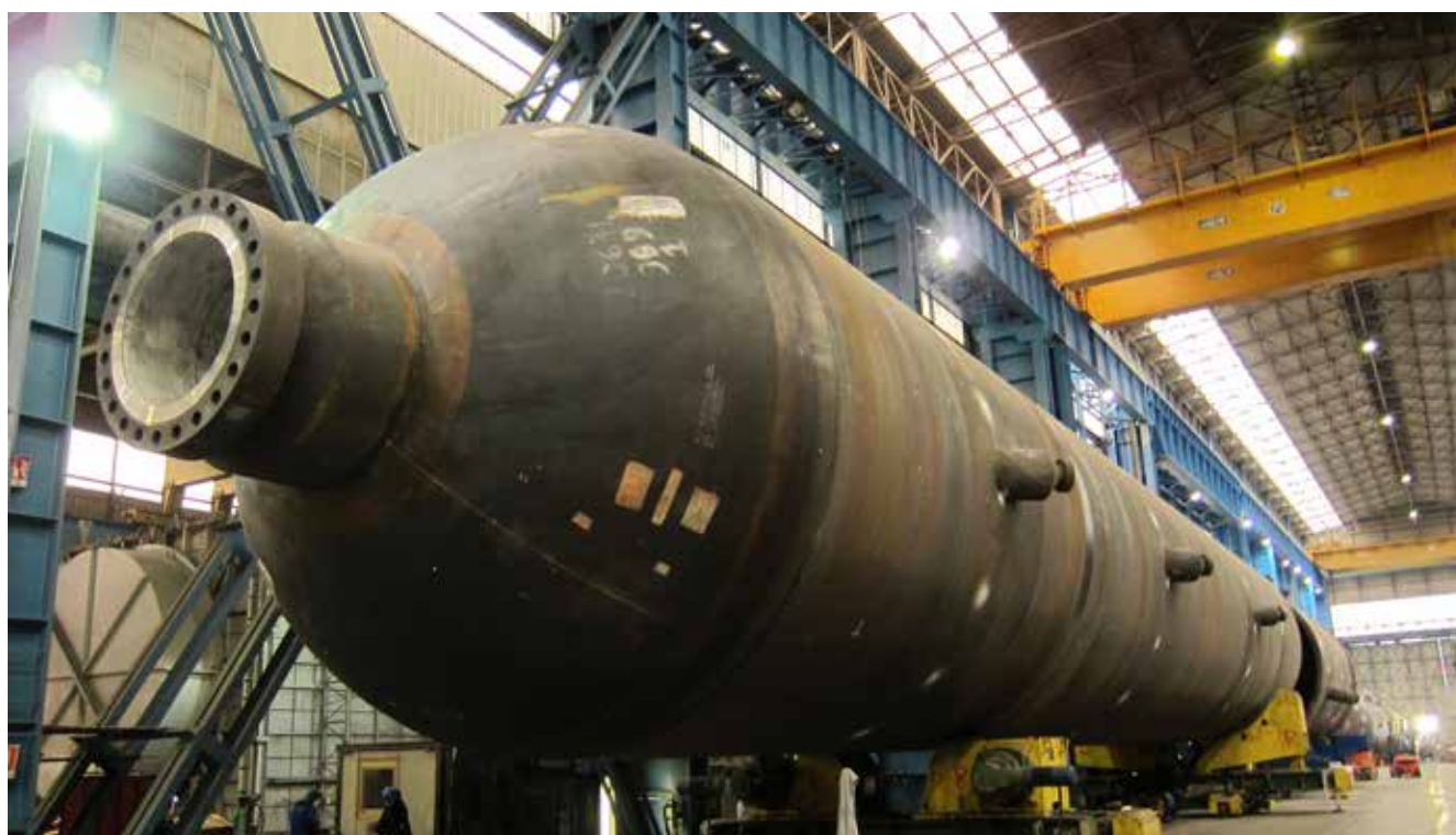
I reattori, del tipo Mild Hydrocracking e processo UOP, saranno tra i più grandi mai prodotti al mondo.
